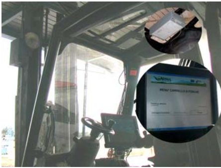
Computer e reader RFID a bordo del muletto
